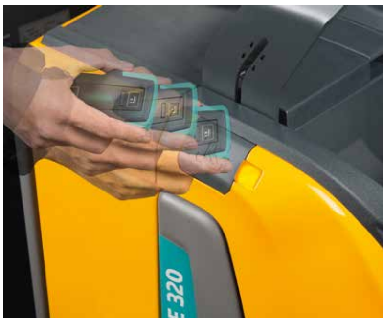
Conexión rápida con cualquier ECE de la flota por sincronización NFC.
