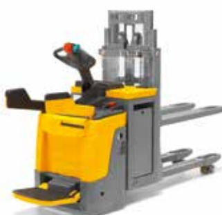
ERD 220 (acompañante/conductor) para pasillos estrechos de trabajo
