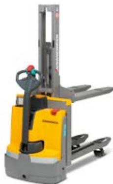
Capacidades de la carga de la EMD 115i/118 en usos de doble piso: Elevación de mástil de 800 kg, elevación de brazo porteador de 1.000 kg
