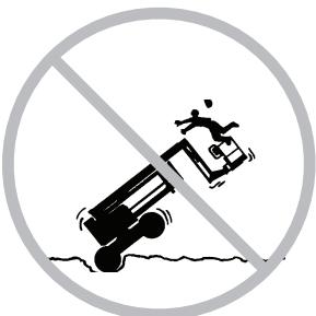
Cuando conduzca la máquina en posición replegada a través de terrenos irregulares, escombros, superficies inestables o deslizantes, o cerca de agujeros y pendientes, extíreme las medidas de precaución y conduzca a baja velocidad.
